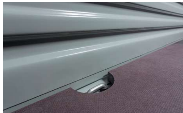
Пол с транспортной фанерой, а крепление груза возможно скрытыми такелажными петлями
